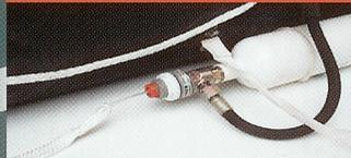
La bouteille de CO<sub>2</sub> contient suffisamment de gaz pour gonfler les radeaux même à des températures inférieures à -15 °C. Il suffit de tirer sur la ligne de déclenchement.
